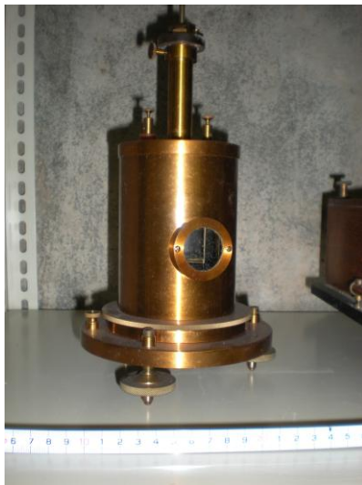
図 8 検流計（ガルバノメータ）
