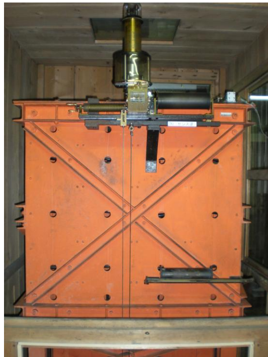
図1 ウィーヘルト地震計。左：水平動，右：上下動
