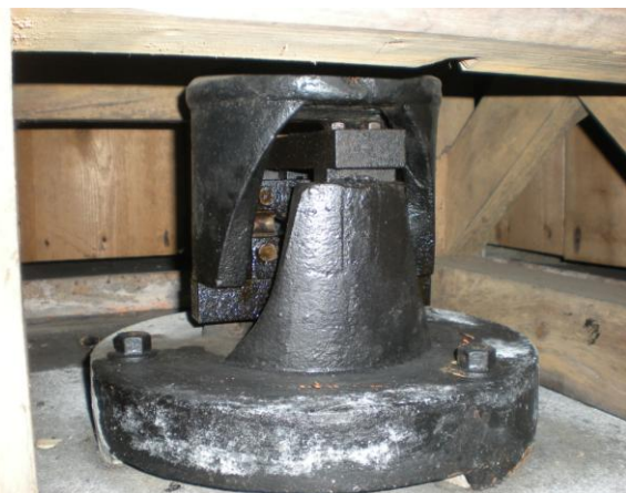
図 12 ウイーヘルト地震の支点 東西・南北、2方向に動く
