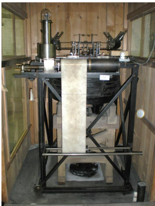
図1 ウィーヘルト地震計。左：水平動，右：上下動
